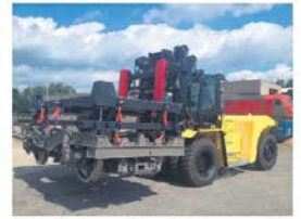
Hydraulische Schwerlasttraverse im DB-Wartungsbetrieb. Tragfähigkeit 16.000 kg
