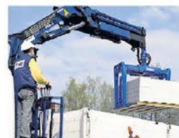
Hydraulik-Steingreifer am LKW-Ladekran
