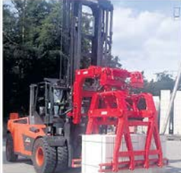
6.000 kg-Hydraulikgreifer gebaut von SH. Einsatz im Kalksandsteinwerk
